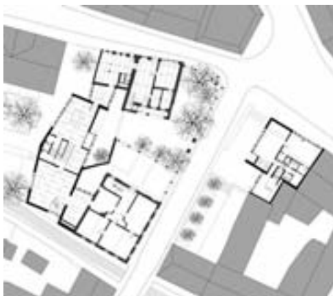
Grundriss der Erdgeschossenebene: Das neue Ausstellungsgebäude verbindet Geburtshaus und Armenschule; auf der gegenüberliegenden Seite der Seminarstraße befindet sich das Besucherzentrum. ▼
