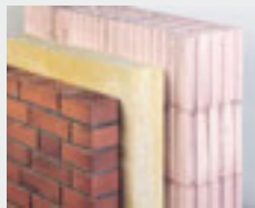
11,5 cm Vormauerziegel 14 cm Mineralwolle 24 cm Porotonziegel
