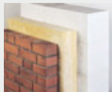
11,5 cm Vormauerziegel 14 cm Mineralwolle 24 cm Porenbeton
